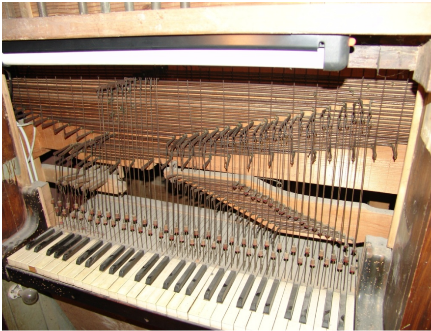
la tastiera con trasmissioni meccaniche
